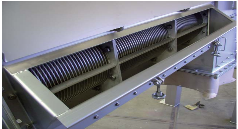
Schoonmaakluik voor het snelreinen van de perskorf
