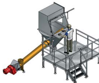
Zakkenstort met doseerschroef en stofafzuiging.
