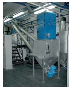
Zakkestort met filterunit en doseerschroef.
