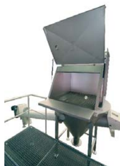
Zakkestort met voeding van een doseerschroef.
