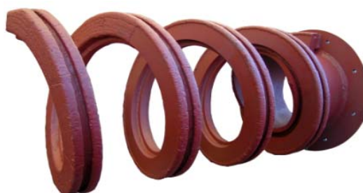
Asloos perslint opgelast met slijtvaste elektrode
