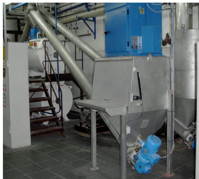
Zakkenstort met filterunit en doseerschroef
