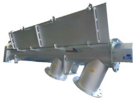
Trogtransporteurs voor de voedingsmiddelenindustrie snelreinigbaar door scharnierende deksels
