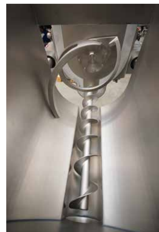
De productconditioner (boven) en de doseerschroef (onder) van de PAF.
