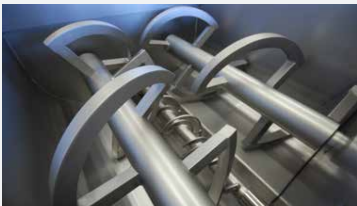
De interne delen van de PTF-500 feeder die binnen het kleurpoeder doseert.
