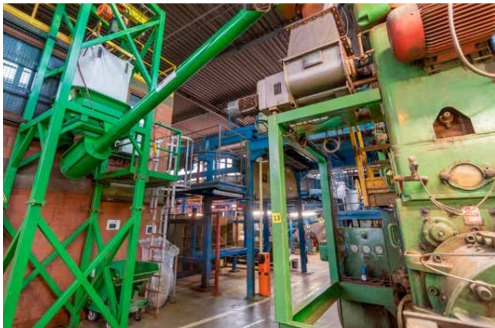
De Precision PTF 500 feeder doseert het bruine kleurpoeder voor de keramische dakpannen.
