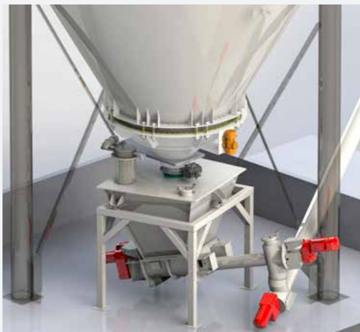
Ontwerptekening van de PTF-750 feeder die buiten het granietpoeder doseert.
